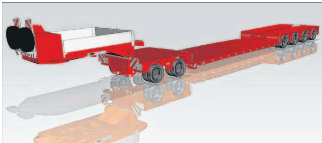
So wie auf dieser CAD-Zeichnung sieht der neuen Tiefbett-Sattelaufleger von Doll aus. Foto: Doll
